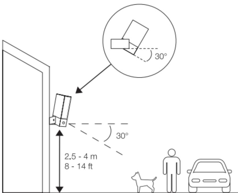
Για βέλτιστη απόδοση, εγκαταστήστε την Κάμερα Presence σε ύψος μεταξύ 2,5 και 4 μέτρα με γωνία κλίσης περίπου  $30^{\circ}$ .
