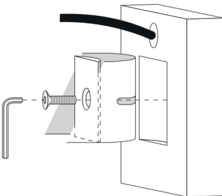
Χρησιμοποιήστε το κάλυμμα βάσης και τη μαύρη βίδα (C) για να στερεώσετε την Κάμερα Presence στη λάμα στήριξης και το πλαισιο.
