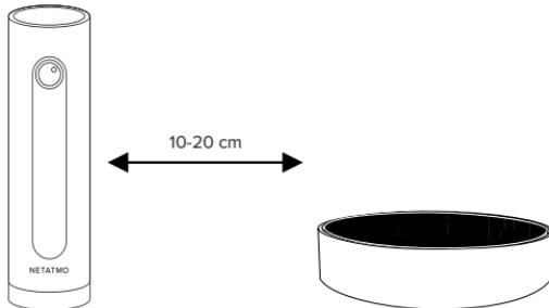
Αφαιρέστε τη βάση στήριξης από τη Smart Σειρήνα Εσωτερικού Χώρου και τοποθετήστε τη δίπλα στην κάμερα σε απόσταση 10 - 20cm.
