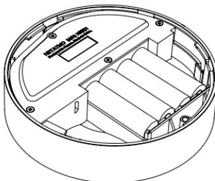
Γυρίστε τη Smart Σειρήνα Εσωτερικού Χώρου αριστερόστροφα για να την αφαιρέσετε από τη βάση στήριξης. Ξεβιδώστε τη βίδα που φαίνεται στο σχήμα, για να ανοίξετε το καπάκι της μπαταρίας. Χρησιμοποιήστε 4 μπαταρίες τύπου AA. Τηρήστε την πολικότητα που υποδεικνύεται στη θήκη της μπαταρίας.
