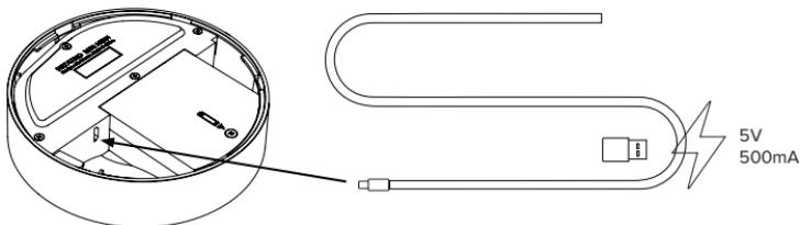
Μπορείτε να χρησιμοποιήσετε έναν αντάπτορα micro USB (5V, 500mA), έτσι ώστε η Smart Σειρήνα Εσωτερικού Χώρου να τροφοδοτείται μόνιμα.
